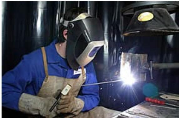
Das Lichtbogenhandschweißen wird hauptsächlich zum Verbinden von Blechen und Rohren aus unlegierten und legierten Stählen eingesetzt.
